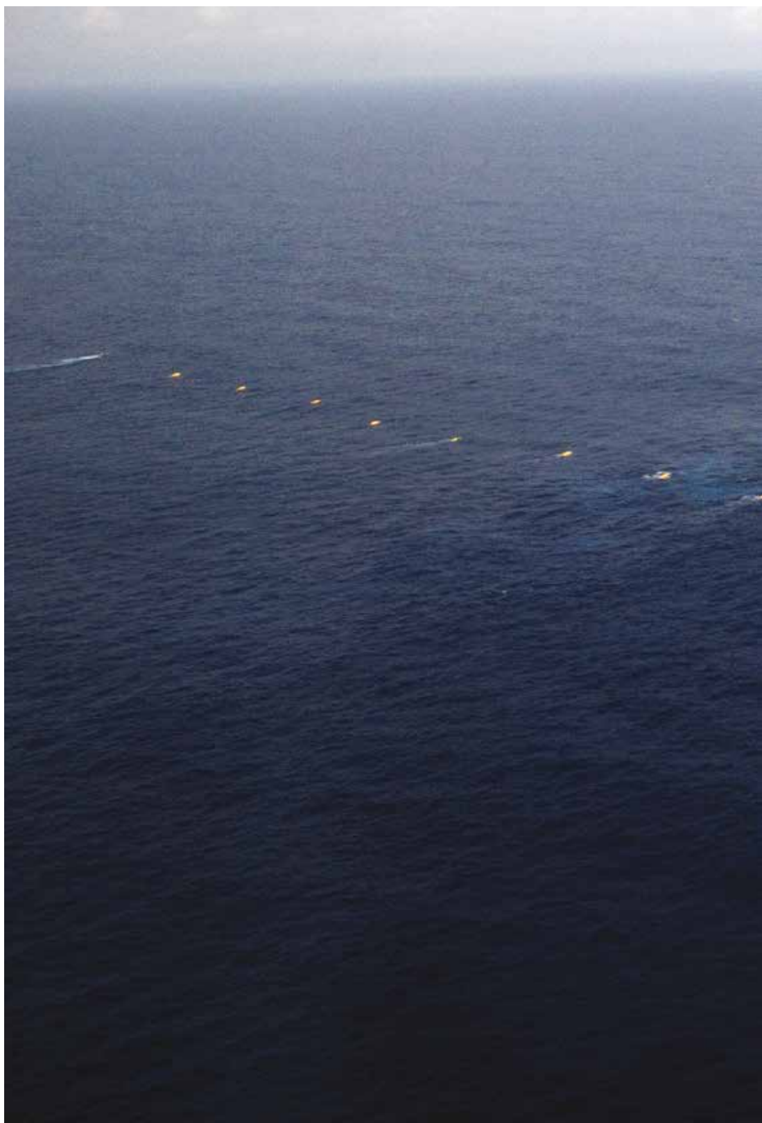
Figura 1: Navio sísmico 3D rebocando cabos sísmicos flutuantes. Fonte: PGS
