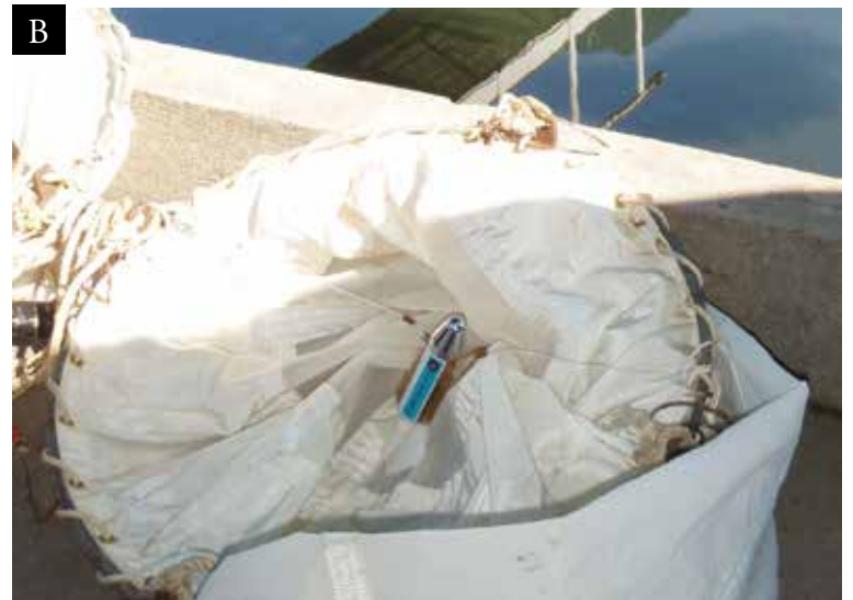
Figura 3 - Rede bongô (a) com fluxômetro (b) acoplado para as coletas de zooplâncton .
