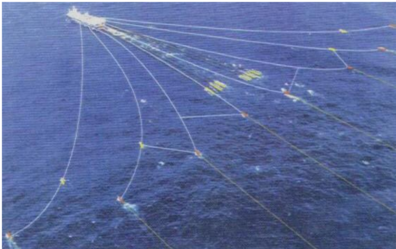
Figura 3 – Aquisição de dados sísmicos em águas profundas: embarcação rebocando os arranjos de canhões de ar e os cabos sísmicos (Thomas, 2001).
